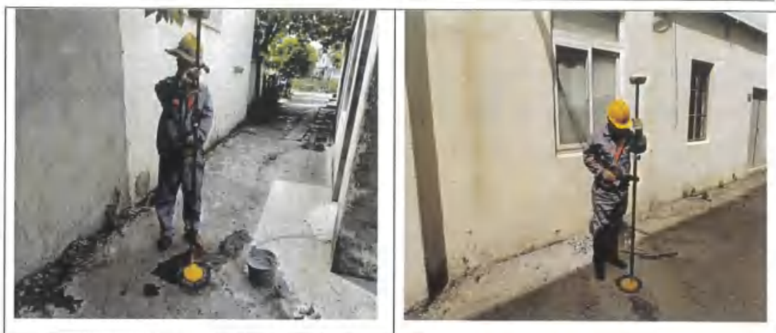
图 5-2 RTK 坐标标高测定
